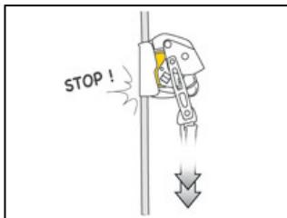
En cas de mouvement brusque (chute, glissade, descente non contrôlée...), l'antichute se bloque sur la corde et immobilise l'utilisateur.
