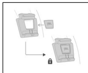
La platine SLOT ADAPT permet de fixer une lampe frontale compatible sur casque VERTEX ou STRATO.
