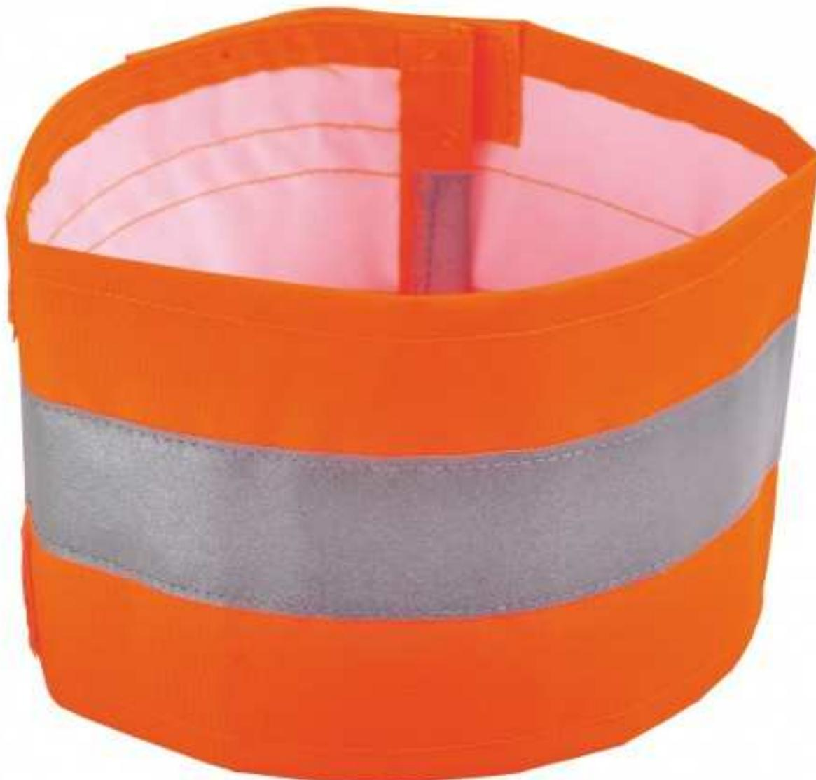
**BRAS\_HV (N°.14585)** Brassard FLUO et RETRO en tissu • Enduit PU orange ou jaune fluo pour signalisation de jour et de nuit • Largeur 90mm avec une bande rétro grise de 30mm • Norme EN13356 • conditionnement : par 10
